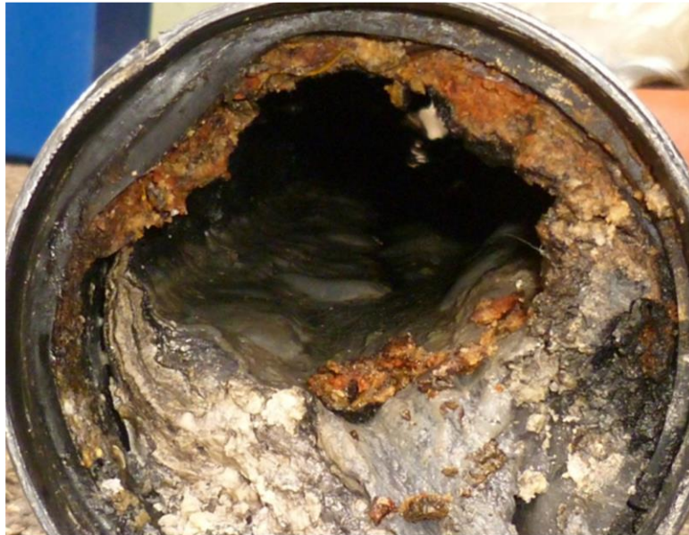
Störfall! Ohne Abscheider setzt sich Fett im Rohr ab!
