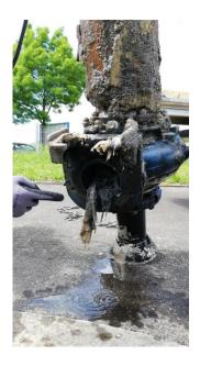
Diese Pumpe aus dem Pumpwerk Schmittenau in Waldshut wurde mit Feuchttüchern verstopft. Sie muss nun komplett auseinandergenommen und gereinigt werden. Das kann, je nach Bauart der Pumpe, mehrere Stunden Arbeitszeit erfordern – unabhängig von der Tageszeit.
